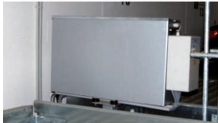
mit Hydraulikverrohrung und Verdrahtung zum Hauptschalter. (Das Unterölaggregat ist leise durch die Motor-Pumpen-Kombination, die Schall absorbiert und gedämmt in Öl liegt). Lieferung inkl. elektrischen Schaltkastens.
