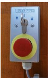
Bedieneinheit bestehend aus Schlüsselschalter mit Not-Aus in Totmannsteuerung und mit Verdrahtung zum Hydraulikaggregat.
