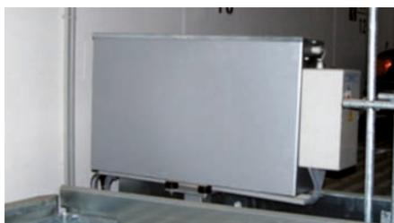
mit Hydraulikverrohrung und Verdrahtung zum Hauptschalter. (Das Unterölaggregat ist leise durch die Motor-Pumpen-Kombination, die Schall absorbiert und gedämmt in Öl liegt). Lieferung erfolgt inkl. elektrischen Schaltkastens.
