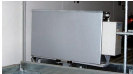
mit Hydraulikverrohrung und Verdrahtung zum Hauptschalter. (Das Unterölaggregat ist leise durch die Motor-Pumpen-Kombination, die Schall absorbiert und gedämmt in Öl liegt). Lieferung inkl. elektrischen Schaltkastens.
