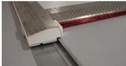
Die Fahrschienen und die Führungsschienen werden bei der Montage der Schiebeplattformen in der Tiefgarage vor Stützen direkt am Boden verdrübelt. Achtung: Bei Anordnung von mehreren Längspaletten nebeneinander ist zu beachten, dass von einem Bedienelement aus nur die Plattformen bewegt werden dürfen, die sich in einem Umkreis von 20m (s.h. DIN EN 14010, Artikel 5.8.4.2) befinden, damit eine optische Überwachung der Bewegung möglich ist.
