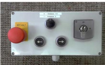
Schlüsselschalter mit Tasten für die Bewegungsrichtung und Not-Aus in Totmannsteuerung mit Kurzbedienanleitung und Verdrahtung zum Aggregat.
