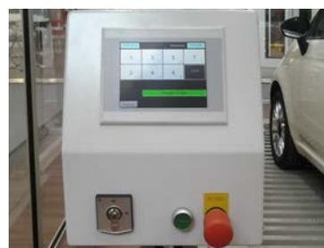
Touch-Screen mit Schlüsselschalter und Not-Aus in Totmannsteuerung.
