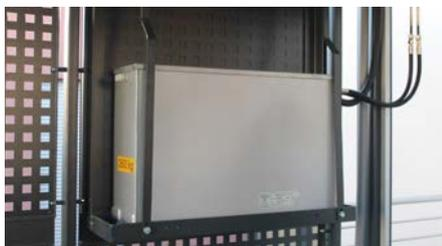
mit Hydraulikverrohrung und Verdrahtung zum Hauptschalter. (Das Unterölaggregat ist leise durch die Motor-Pumpen-Kombination, die Schall absorbiert und gedämmt in Öl liegt).
