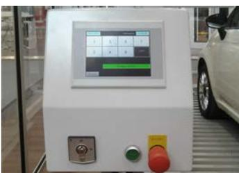
Bedienung über Touchscreen, aktivierbar mit Schlüsselschalter. Not-Ausschalter für Notfälle. Kurzbedienanleitung an der Wand. Verdrahtung zum Aggregat.
