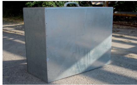
Schallschutzhaube für das Aggregat
