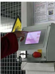
Bedienung über Touchscreen, aktivierbar mit Schlüsselschalter. Not-Ausschalter für Notfälle. Kurzbedienanleitung an der Wand. Verdrahtung zum Aggregat.
